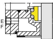
Kühlflansch, alternativ anwendbar als Heizflansch (tmax. = 350°C (662 °F)).
